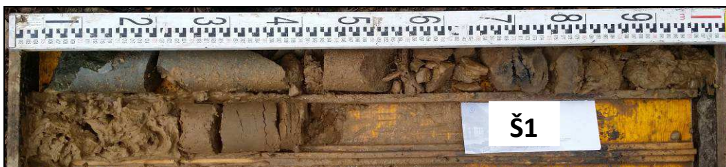
Obr. č. 2 - diagnostický vrt Š1 - pod úroveň základové spáry opěry Troubelice
