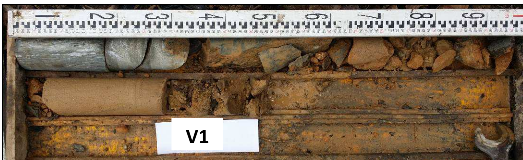
Obr. č. 1 - diagnostický vrt V1 - za rub opěry Troubelice
